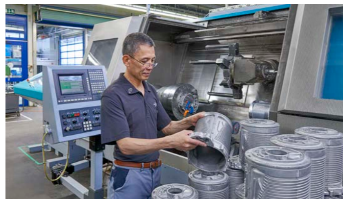
Die Drehdurchmesser für neue Motorengehäuse erfordern besondere Anlagen. Bei Rees Zerspanungstechnik werden Werkzeugmaschinen für einen Durchmesserbereich bis zu 330 mm mit neuen konstruktiven Lösungen kombiniert.
